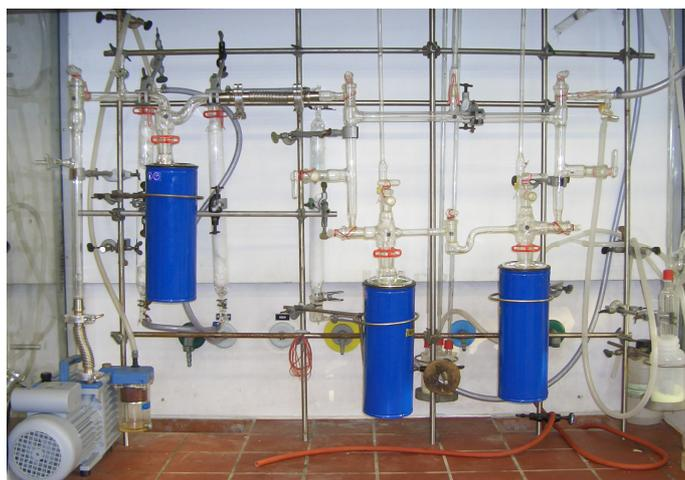
Abb. 6-1 Modifizierte Stock'sche Vakuumapparatur.
