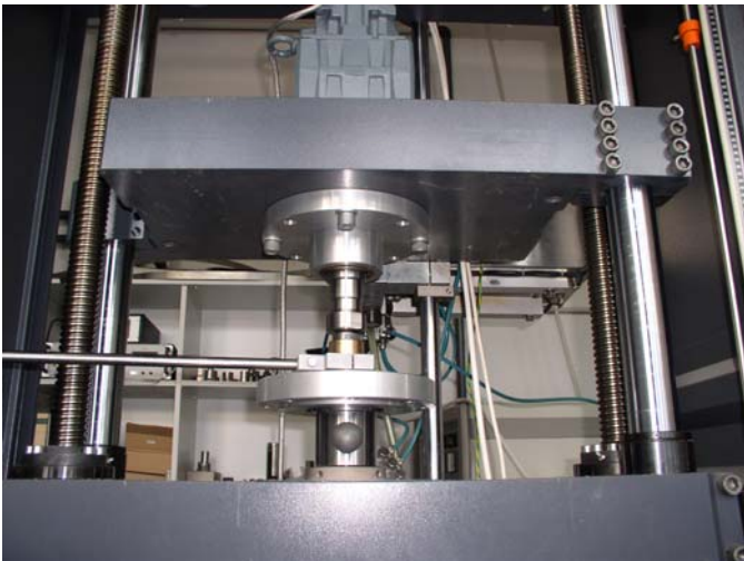
Bild 1: Gesamtaufnahme der umgebauten Universalprüfmaschine Zwick 1776: Auf dem oberen Rahmen ist der Antrieb montiert, auf der verfahrbaren Traverse ist die Kraftmessdose zur Druckmessung einschließlich der Probenhalterung mit dem Ausleger zur Drehmomenterfassung befestigt.
