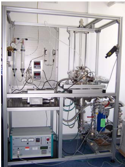
Bild 1: Eigenkonstruktion eines LP-CVD-Systems.
