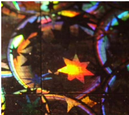
Bild 1: Geprägte holographische Struktur, welche im One-Step-Verfahren hergestellt wurde.
