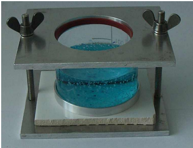
Bild 1: Photoreaktor, welcher für die Photodegradationsexperimente auf keramischen Substraten entwickelt wurde.
