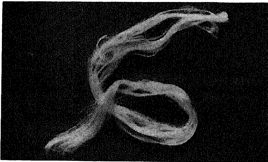
Bild 1. \text{SiO}_2 -Faser, hergestellt durch einen kontinuierlichen Faserziehprozeß aus einem Sol /16/.
