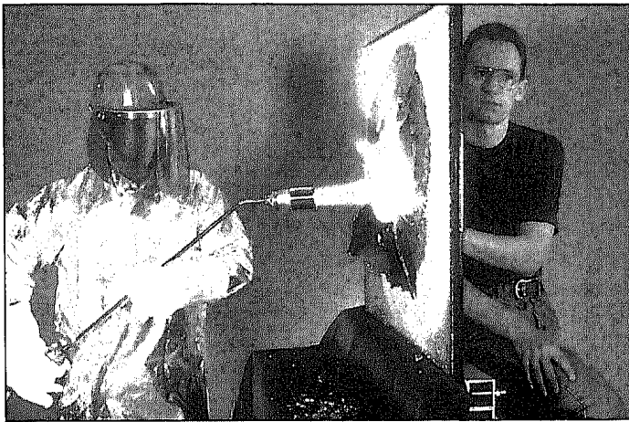
Abb. 12a: Laborentwicklung der ersten Brandschutzscheibe auf Nanopartikelbasis (b, c und d siehe O-E)
