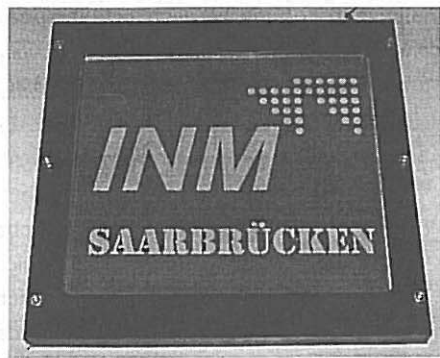
Bild 2: Memory-Effect beim EC-Display nach 5 Tagen ohne Energiezufuhr
