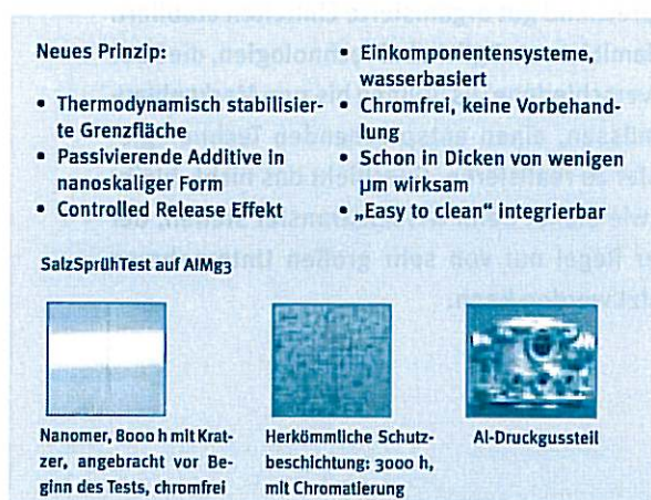
Bild 7: Chromfreier Korrosionsschutz auf Leichtmetallen
