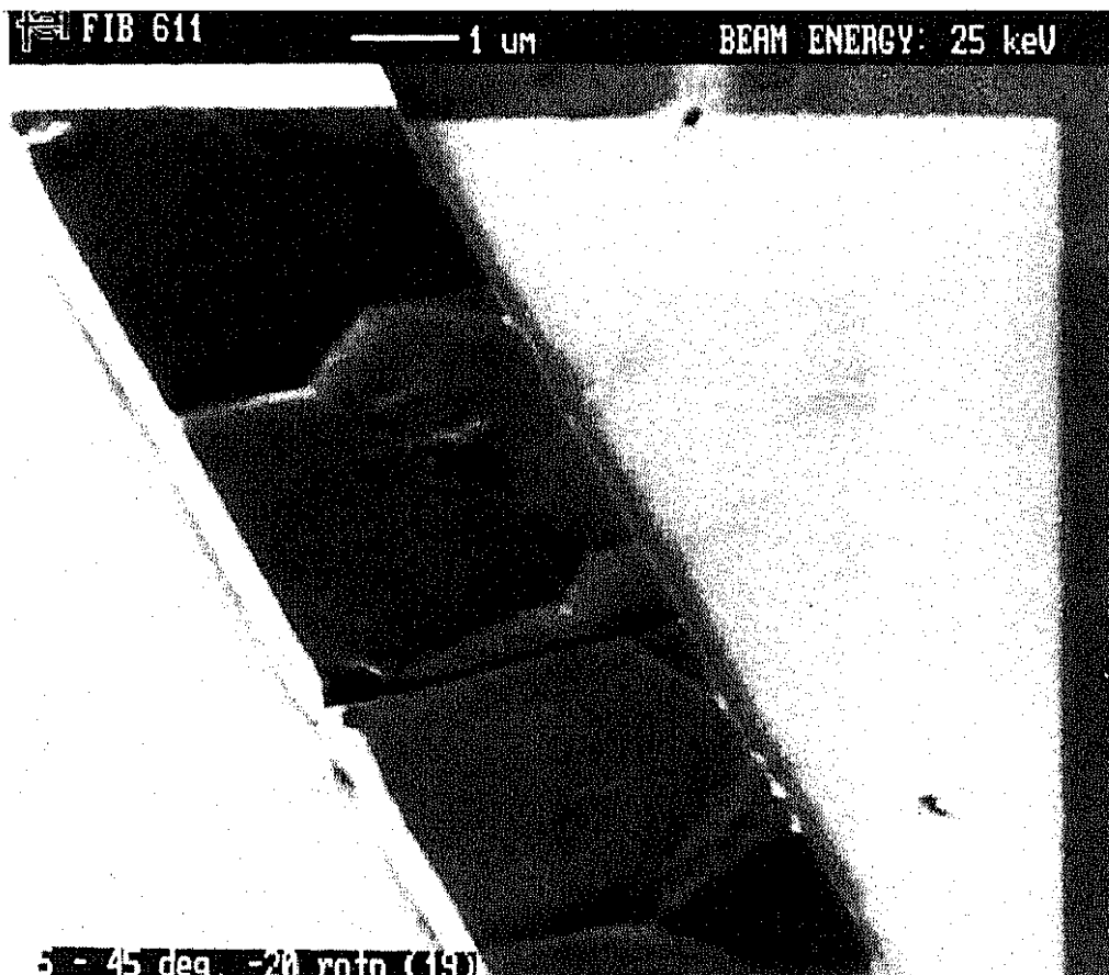
Abb. 23: Beispiel für den glatten „Sprödbbruch“ einer Leiterbahn aus einem an sich gut verformbaren Material (Foto: J. Sanchez, Max-Planck-Institut für Metallforschung).
