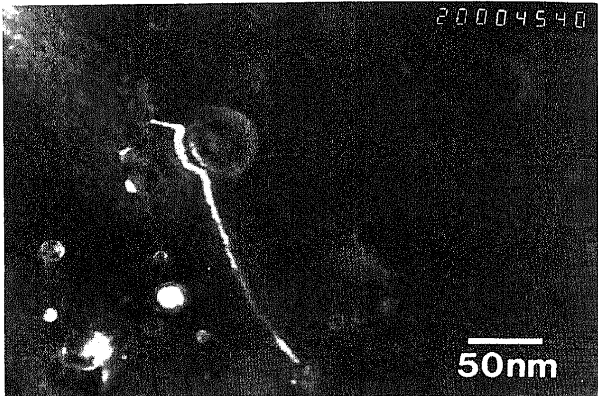
Abb. 13: Ergebnis ausführlicher elektronenmikroskopischer Untersuchungen: Versetzungen unterliegen bei hohen Temperaturen einem unerwarteten Effekt, sie bleiben an den Teilchen „kleben“. Die auf dieser Beobachtung aufbauende Theorie erklärt die Festigkeit vieler Hochtemperaturlegierungen und erlaubt ihre gezielte Weiterentwicklung (Foto: J. Schröder, Max-Planck-Institut für Metallforschung).
