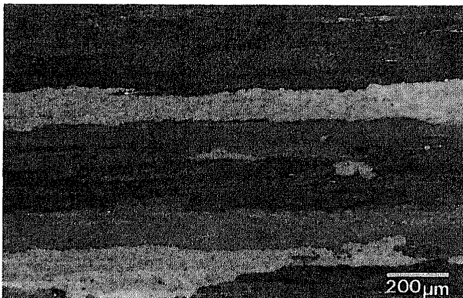
Abb. 3: Langgestrecktes Korngefüge einer ODS-Legierung; Niederschlagsätzung Beraha III.
