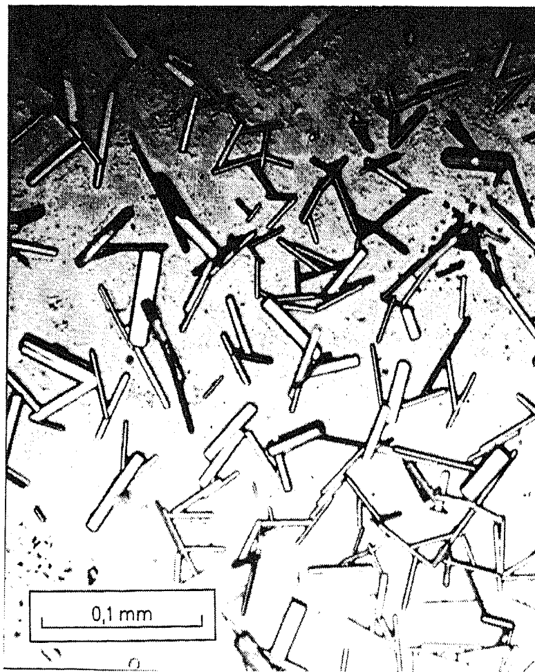
Bild 8: Syngenitkristalle (Klimaschrankbewitterung, Originalglas vom York Minster, 15. Jh.)
