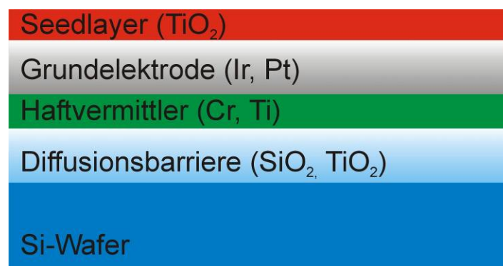
Abbildung 3.5: schematischer Aufbau der verwendeten Substrate: Auf einen Siliziumwafer wird zunächst eine Diffusionsbarriere ( \text{TiO}_2 oder \text{SiO}_2 ) abgeschieden und thermisch oxidiert. Im darauf folgenden Sputter-Verfahren wird hierauf zunächst eine Haftvermittlerschicht (grün, Chrom oder Titan) und dann die Grundelektrode (grau, Iridium oder Platin) abgeschieden. Wahlweise kann ein Seedlayer (rot) aus \text{TiO}_2 aufgedampft werden.
