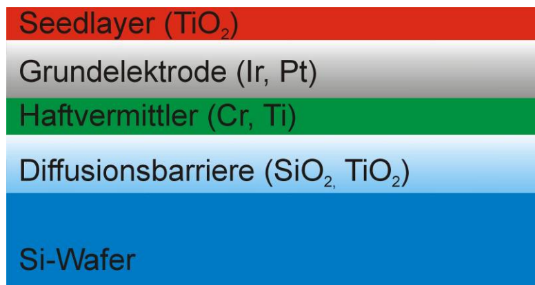
Abbildung 2.35: Typischer Aufbau eines Substrates zur Abscheidung von PZT
