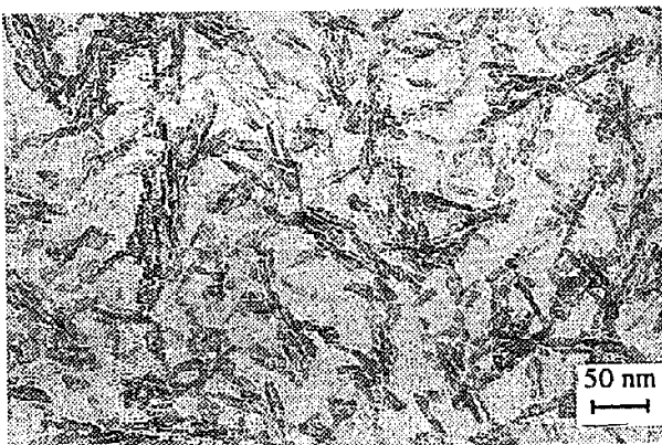
Bild 3: TEM-Aufnahme von HAP-Pulver synthetisiert bei T_{\text{syn}} = 20 °C.
