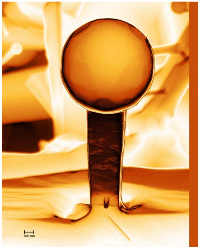
Abbildung 96: REM-Aufnahme eines einzelnen Nanodrahts von CVD600 in Falschfarben; Vergrößerung 43000 x
