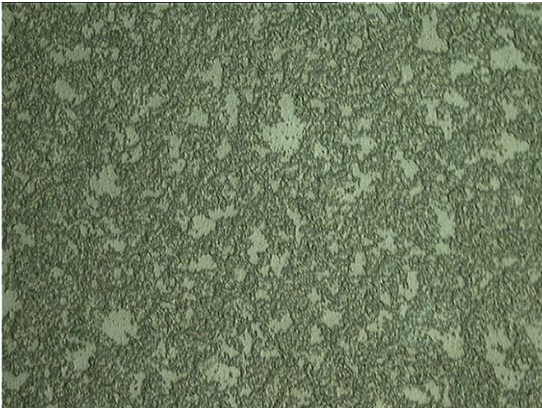
Abbildung 49: Lichtmikroskopische Aufnahme (Vergrößerung: 50x) einer Schicht aus Isopropanol-Lösung; helle Flächen sind unbeschichtete Substratbereiche
