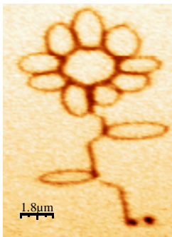
Bild 1 AFM Abbild eines aus durchgezogenen Linien bestehenden Musters geschrieben in einen kommerziell erhältlichen Photolack im kontinuierlichen Belichtungsmodus.
