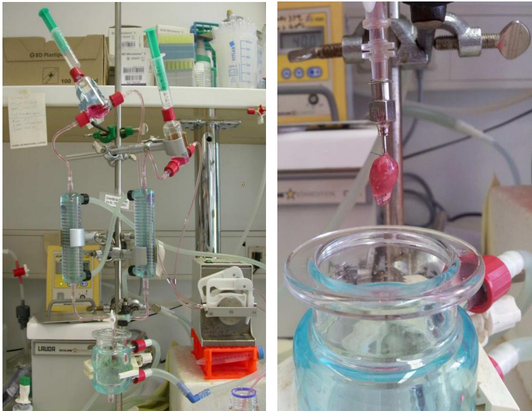
Abbildung 6: Herz in Langendorff-Perfusionsanlage
