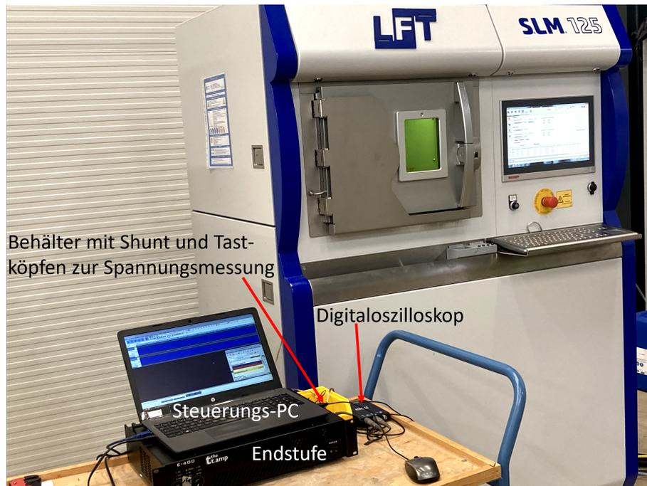
Abbildung 8.23: Steuerungseinheit der Baujobbeschallung mit Spannungsmessaufbau über Tastköpfe und ein Digitaloszilloskop
